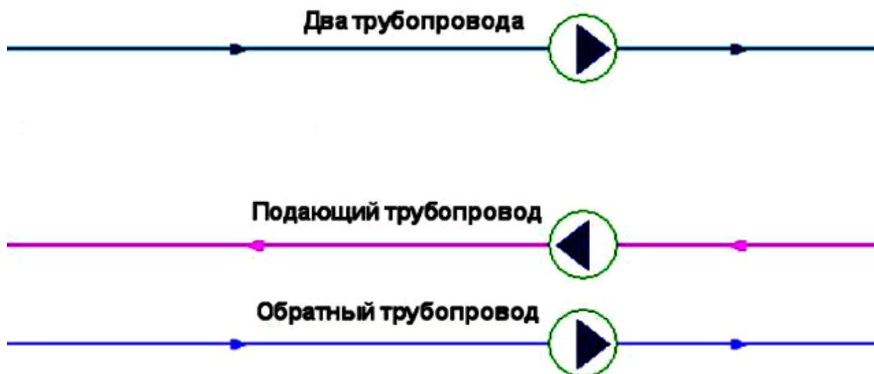
Рис. 13 Сверху: однолинейное изображение, снизу – внутреннее представление
